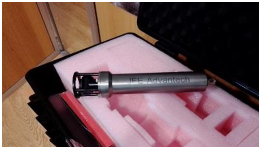
Figura 5.-Sonda INFINITY-CT empregada no proxecto para o rexistro continuo de temperatura e salinidade na zona de Arcade.
