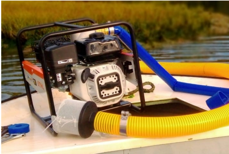
Figura 2.- Bomba de alimentación do aparato de remoción hidráulica.
